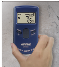
测量混凝土含水率
