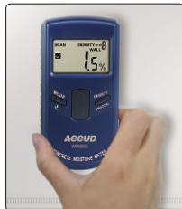
测量墙壁含水率
