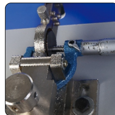
研磨外径千分尺测量面
